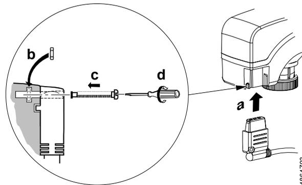
Кабельный Коннектор входит в паз, но он может быть дополнительно укреплен стопорным винтом.
