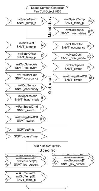
Fig. 12. FCU Controller Object
