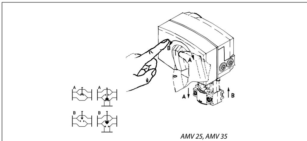
Ручное позиционирование производится поворотом рукоятки до нужного положения. Проверить правильность направления вращения шпинделя.
