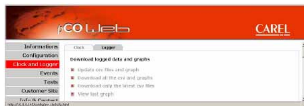
Рис. 5.d – Загрузка регистратора и графиков
